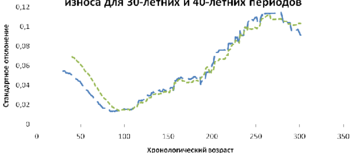
Рис. 4. Изменение стандартного отклонения среднего физического износа для зданий с кирпичными стенами
