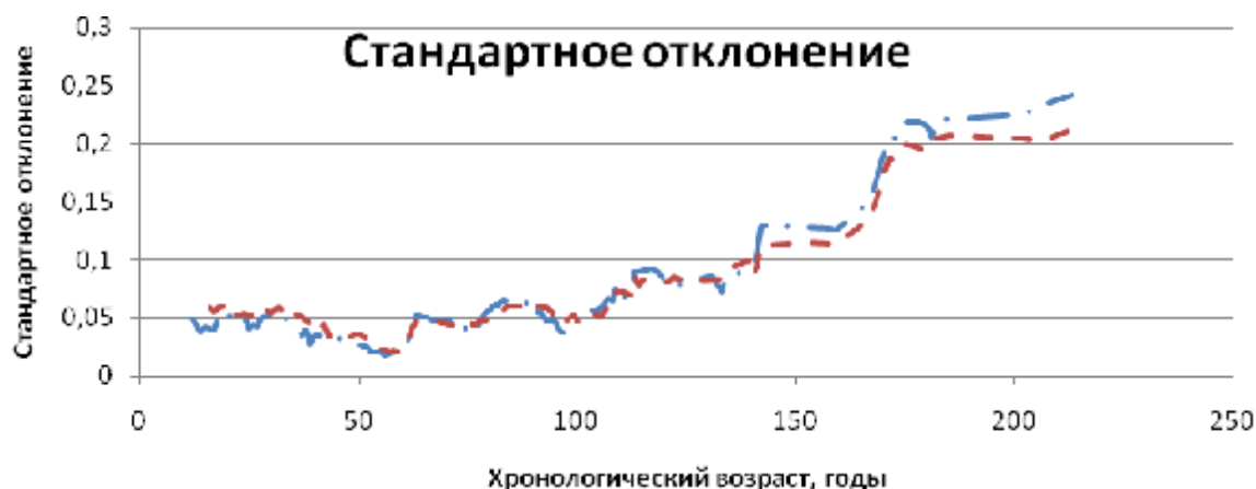
Рис. 7. Изменение стандартного отклонения среднего физического износа для «деревянных» зданий
